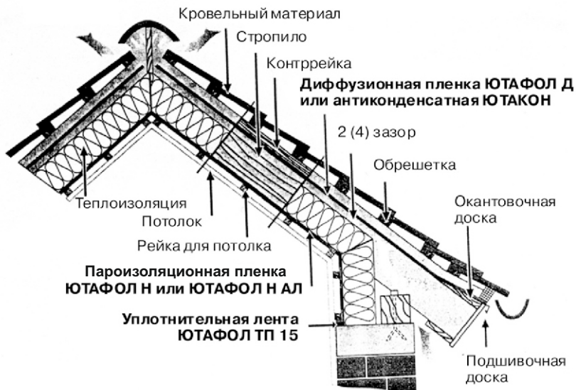
Рис. 6. Кровельная конструкция над отапливаемым пространством
