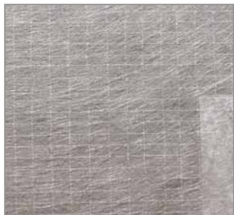
**ПОЛИЭФИРНАЯ АРМИРОВАННАЯ ОСНОВА** ПОЗВОЛЯЕТ КАЧЕСТВЕННО, С ГАРАНТИЕЙ СРОКА СЛУЖБЫ 25 ЛЕТ И БОЛЕЕ, ВЫПОЛНЯТЬ КРОВЛИ С БОЛЬШИМ УКЛОНОМ И БЫТЬ УВЕРЕННЫМИ В НАДЕЖНОСТИ И ДОЛГОВЕЧНОСТИ ГИДРОИЗОЛЯЦИИ.
