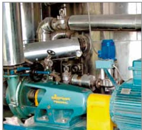
Гомогенизатор позволяет добиться высокого качества битумно-полимерной смеси.
