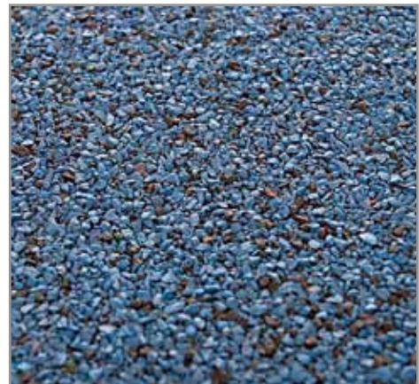
СЛАНЕЦ ИМЕЕТ ПРОЧНОЕ СЦЕПЛЕНИЕ С БИТУМНО-ПОЛИМЕРНЫМ ВЯЖУЩИМ КРОВЕЛЬНОГО МАТЕРИАЛА. И КАК СЛЕДСТВИЕ – САМОЮ ВЫСОКУЮ УСТОЙЧИВОСТЬ К СХОДУ (ПОТЕРЕ) ПОСЫПКИ.
