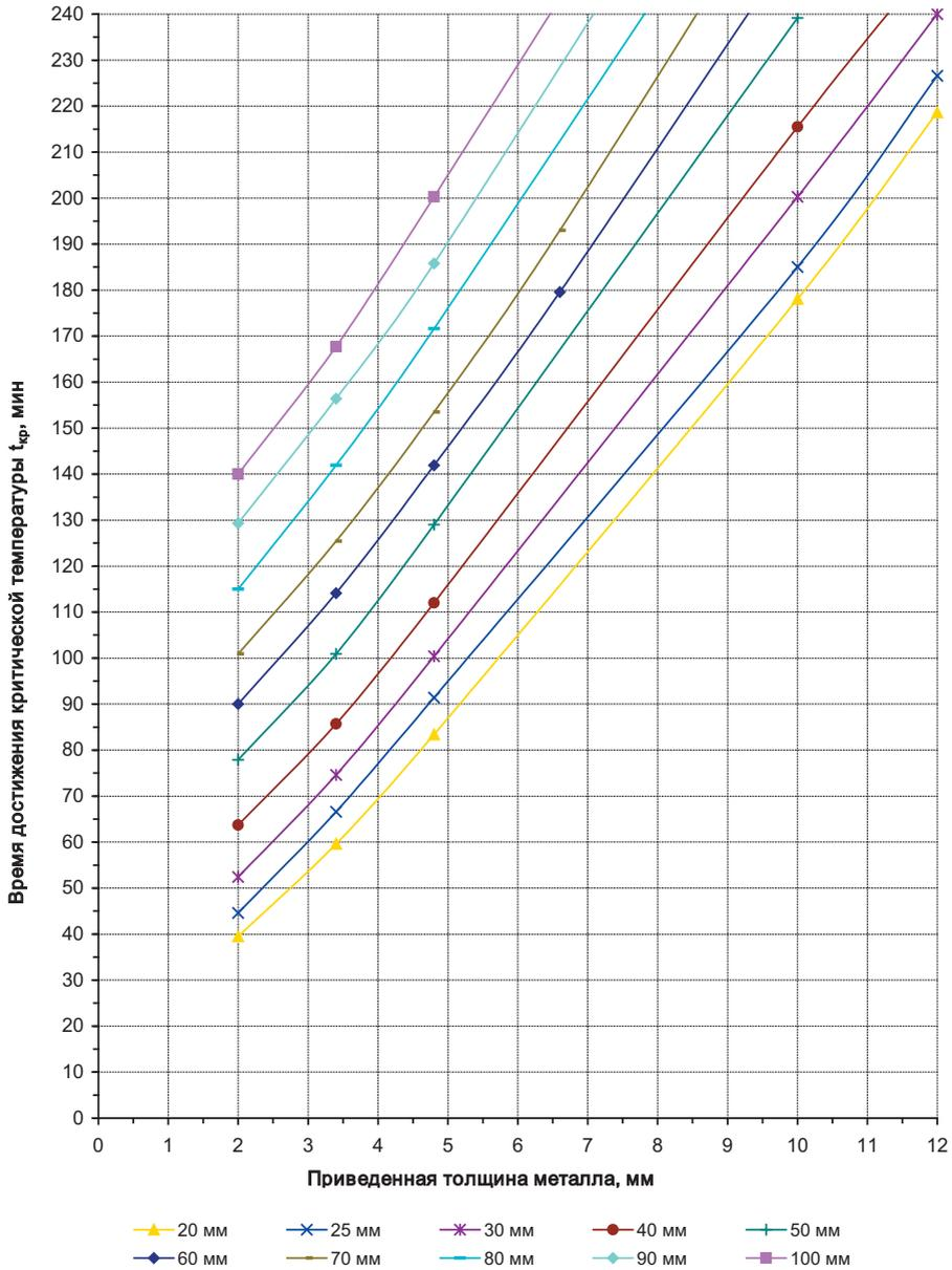
**Рисунок 6.** Огнестойкость стальных конструкций с огнезащитой из минераловатных плит Rockwool серии Conlit SL 150 при  $t_{кр} = 500\text{ °C}$ .
