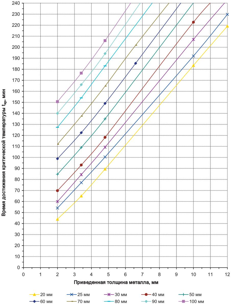
**Рисунок 7.** Огнестойкость стальных конструкций с огнезащитой из минераловатных плит Rockwool серии Conlit SL 150 при  $t_{кр} = 550\text{ }^{\circ}\text{C}$ .
