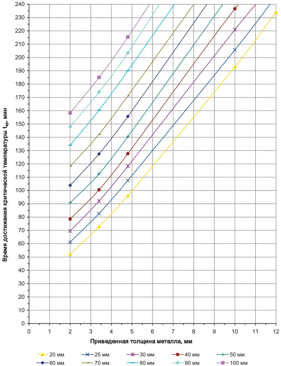
**Рисунок 8.** Огнестойкость стальных конструкций с огнезащитой из минераловатных плит Rockwool серии Conlit SL 150 при  $t_{кр} = 600\text{ °C}$ .
