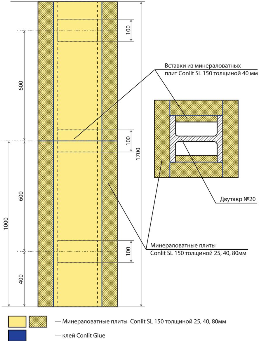
Для построения номограмм были использованы температурные кривые прогрева колонн, облицованных минераловатными плитами Rockwool серии Conlit SL 150, со следующими параметрами:
