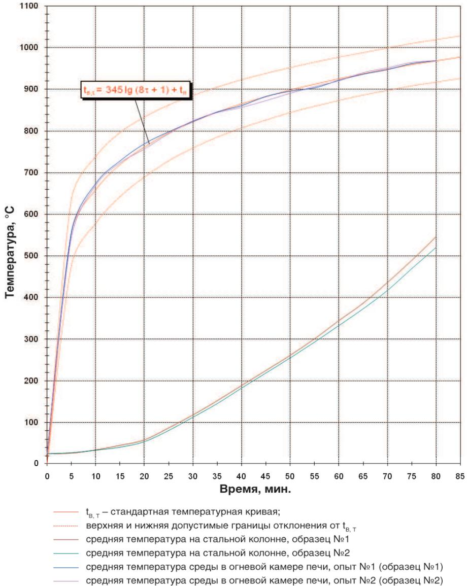
**Рисунок 3.** Температурные кривые прогрева опытных образцов стальных колонн (двутавр № 20) с композицией огнезащитной выполненной из плит теплоизоляционных из минеральной (каменной) ваты Conlit SL 150 толщиной 40 мм и клея Conlit Glue.
