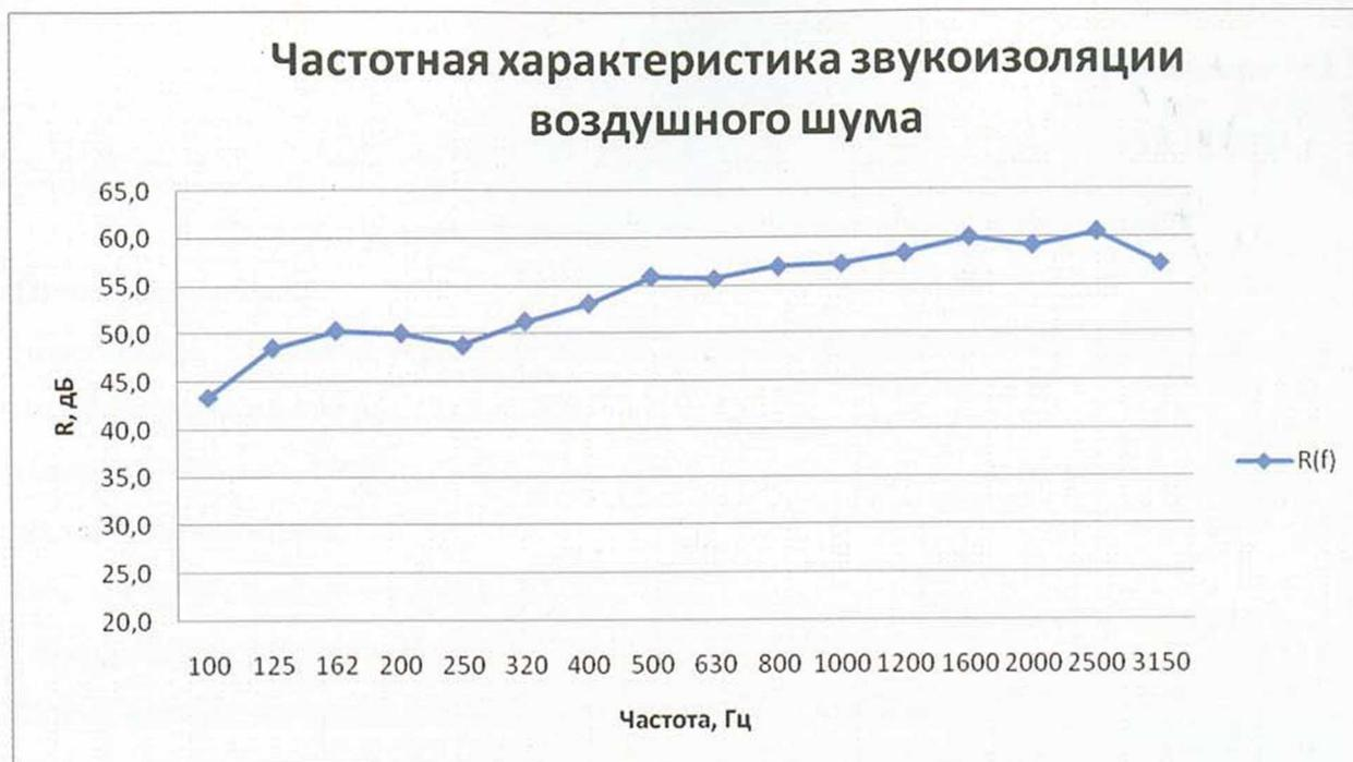
Рис.7. Частотная характеристика изоляции воздушного шума конструкции 2.
