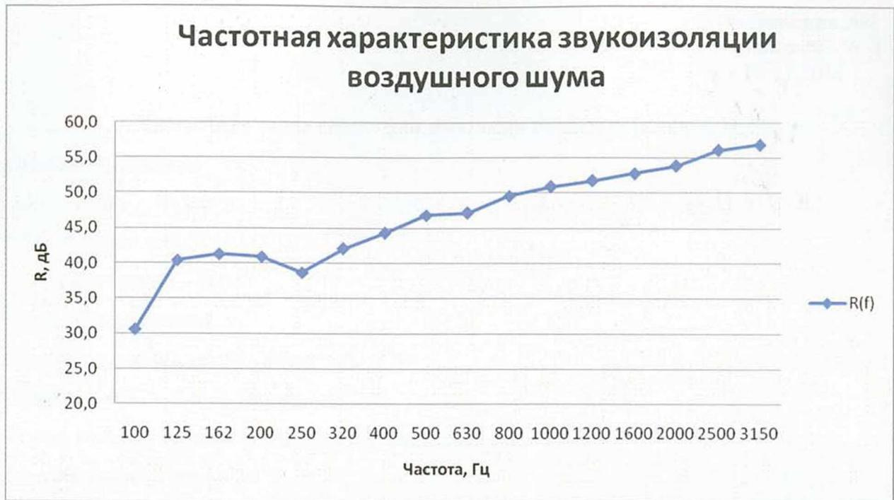
Рис.6. Частотная характеристика изоляции воздушного шума конструкции 1.
