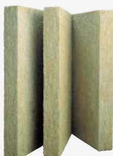
Жесткие гидрофобизированные теплоизоляционные плиты, изготовленные из каменной ваты на основе базальтовых пород, используются в качестве нижнего слоя в двухслойных кровельных покрытиях.
