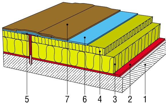
1 – несущая железобетонная плита покрытия;
