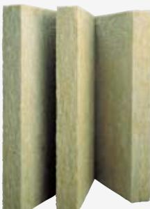
Жесткие гидрофобизированные из каменной ваты плиты, изготовленные из каменной ваты на основе базальтовых пород, используются в качестве теплозвукоизоляционного слоя в кровельных покрытиях.
