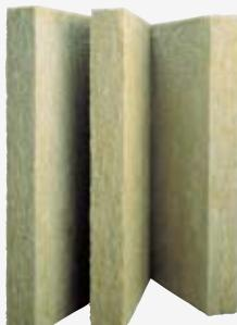
Жесткие гидрофобизированные теплоизоляционные плиты на синтетическом связующем, изготовленные из каменной ваты на основе базальтовых горных пород. Сконструированы в соответствии с принципом двойной плотности. Благодаря этому плиты обладают уменьшенным весом, удобны при монтаже. Толщина верхнего (плотного) слоя 15 мм.
