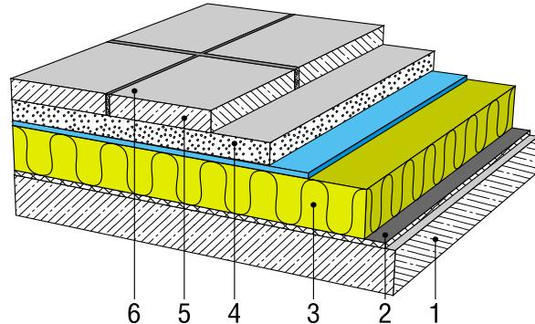
1 – несущая железобетонная плита покрытия;
