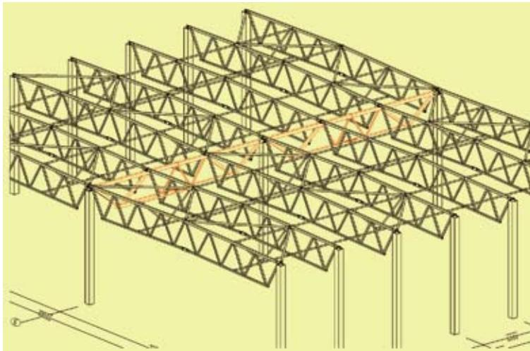
Каркас ферменной конструкции системы «Трасскон»
