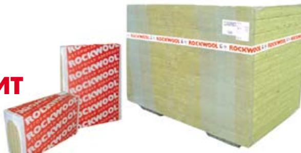
Жесткие гидрофобизированные теплоизоляционные плиты на синтетическом связующем, изготовленные из каменной ваты на основе базальтовых горных пород. Сконструированы в соответствии с принципом двойной плотности. Благодаря этому плиты обладают уменьшенным весом, удобны при монтаже. Толщина верхнего (плотного) слоя 15 мм.
