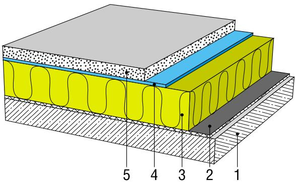
1 – несущая железобетонная плита покрытия;
