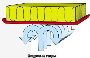
Основным назначением пароизоляционного слоя служит недопущение водяных паров из теплого помещения в утеплитель. Водяной пар, постоянно проходящий сквозь утеплитель снижает общее сопротивление теплопередаче, поэтому пароизоляция всегда должна быть уложена с тёплой стороны утеплителя.
