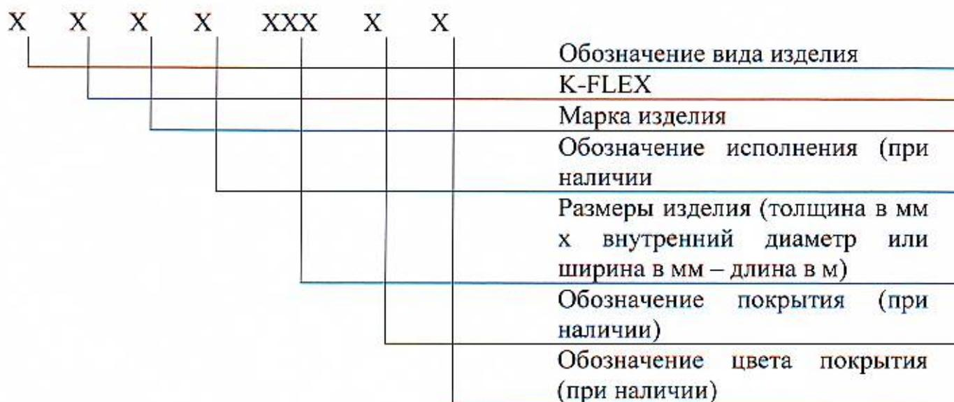
Пример записи условного обозначения изделия теплоизоляционного из вспененного каучука «K-FLEX» марки ST в виде трубки с толщиной стенки 9 мм, внутренним диаметром 28 мм, длиной 2 м при заказе и в другой документации:
