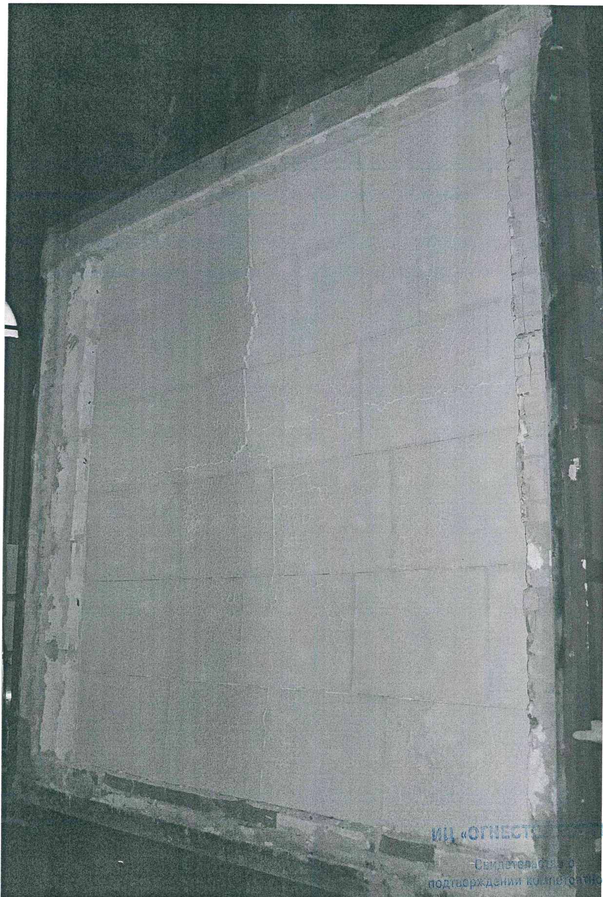
Фото. 3. Образец после испытания (обогреваемая сторона)
