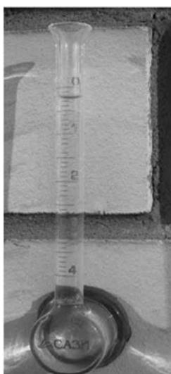
ризонтальной и для вертикальной поверхности. Он состоит из стеклянного колокола диаметром 30 мм с встроенной градуированной трубкой. При заполнении трубы водой до верхней отметки в основании трубы создается давление в 120 мм водяного столба. При помощи пластилина (герметика) трубка крепится к испытуемой поверхности, в нее заливается вода и отслеживается изменение уровня за 2 часа.
